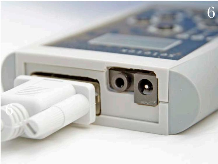
**FIGURA 6.** El Tarsero tiene tres enchufes. El DB9 que se conecta al motor, la entrada de alimentación 12V y otra toma para enchufar motores con cables tipo «Jack».
